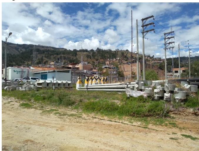
Figura 3. Almacenamiento de accesorios de concreto
