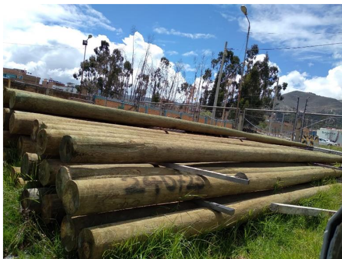
Figura 5. Almacenamiento de postes de madera
