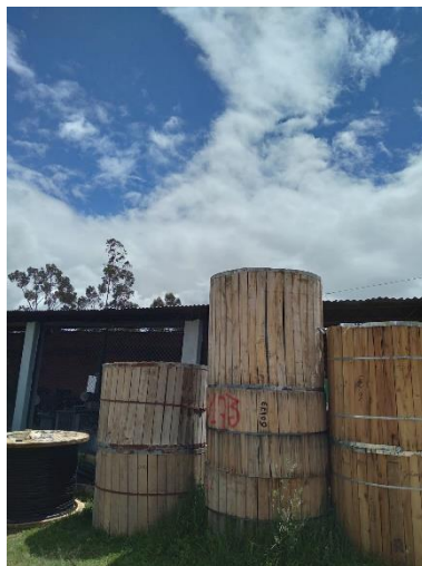
Figura 7. Almacenamiento de conductores nuevos
